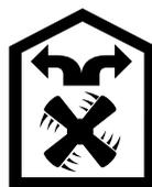
Всасываемый воздух очищается жировоулавливающими фильтрами и фильтрами с активированным углём и поступает обратно в кухню.
