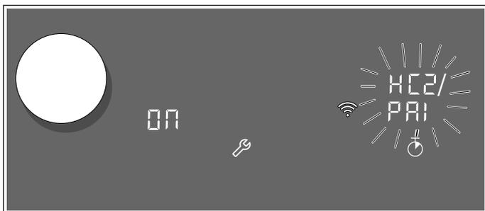
Прибор пытается автоматически установить соединение с приложением. В зоне настройки поочередно мигает индикация **HC2** и **PA1**. На индикаторе конфорки мигает значение **ON**.
