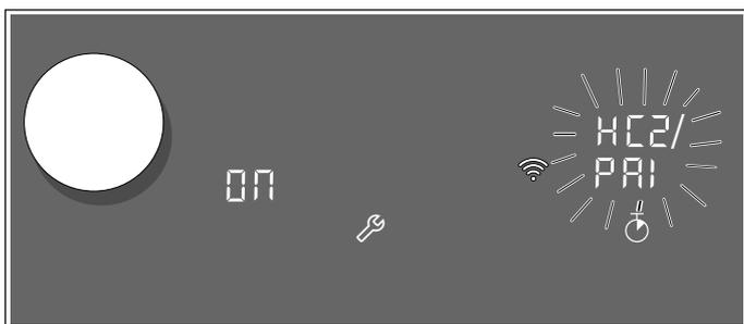
Прибор пытается автоматически установить соединение с приложением. В зоне настройки поочерёдно мигает индикация **НС2** и **РА1**. На индикаторе конфорки мигает значение **ON**.
